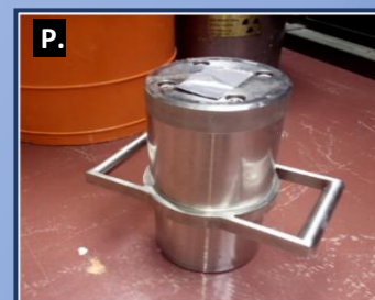
P - UKI4 tienenie z uránu, použitie pre transport nosičov uzavretých zdrojov ionizujúceho žiarenia ( ^{192}\text{Ir} , ^{75}\text{Se} )
