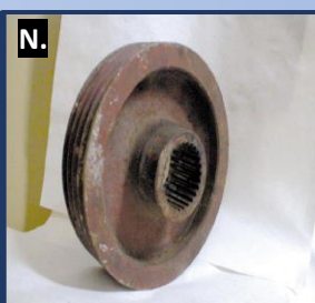
M, N - Súčiastky poľnohospodárskych strojov, vyrobené z tavby kontaminovanej ^{60}\text{Co}
