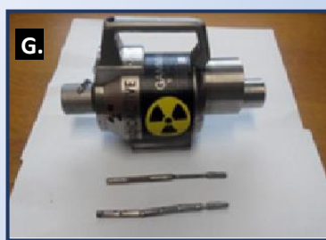
G - GAMMATAT – najrozšírenejší typ defektoskopického krytia
