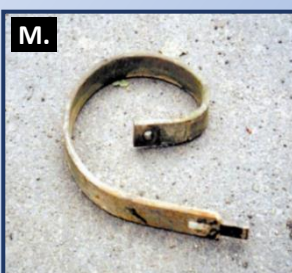
M, N - Súčiastky poľnohospodárskych strojov, vyrobené z tavby kontaminovanej ^{60}\text{Co}
