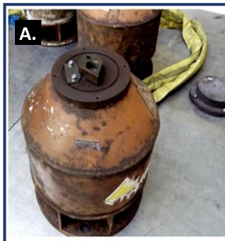
A – Hladinomer MDG301 ( ^{60}\text{Co} , ^{137}\text{Cs} )
