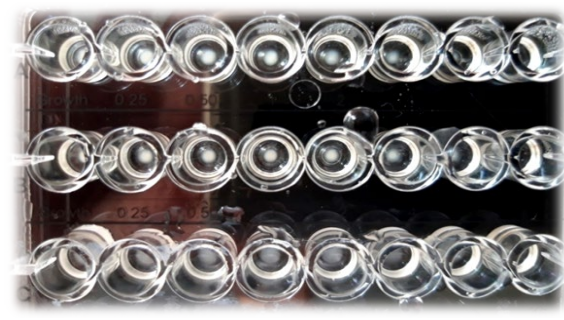
Obr. 1: Mikrodilučná metóda stanovenia citlivosti na kolistín
